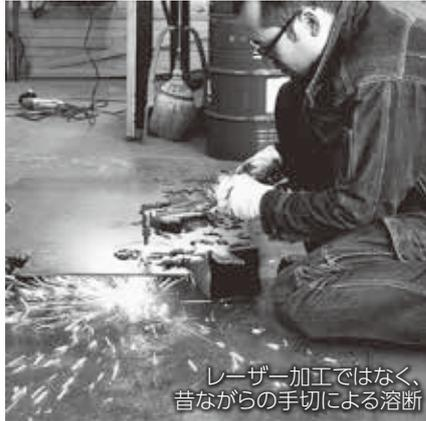
レーザー加工ではなく、昔ながらの手切による溶断
